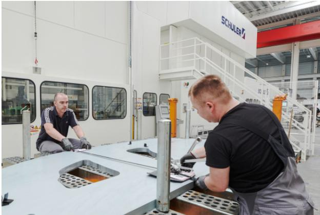
Bild 2 (fri201841910.jpg): Stahlo Stahlservice stellt am Standort in Gera auf einer der größten Platinenschneidanlagen Europas kundenspezifische Formplatinen mit besonderer Oberflächenqualität her und kann ultrahochfeste Stähle mit bis zu 1.900 MPa Festigkeit verarbeiten.
